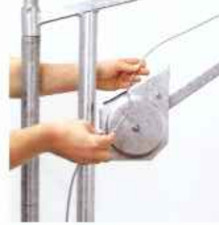
Канат легко пропущается через блок поворотной стрелы, не требуя его разборки.
