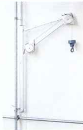
Стандартная поворотная стрела подъемника GEDA-MAXI 120/150 S может крепиться на любом уровне лесов.
