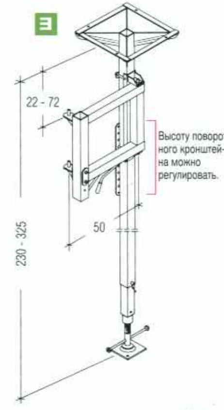
Зажимное устройство для любых лесов из стальных труб размером 1 1/2" подходит для всех подъемников GEDA с поворотной стрелой.
