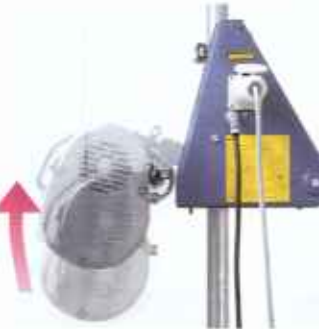
Встроенный концевой выключатель останавливает подъем: • как только груз достигает стрелы • в случае перегрузки • в случае застревания каната в лесях
