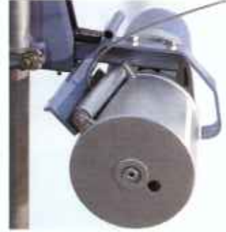
При ослаблении натяжения каната двигатель подъемника отключается, а канат остается туго натянутым на барабан.
