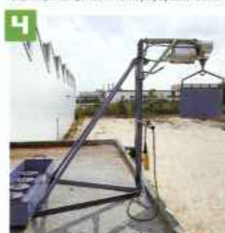
Свободно стоящая тренога с ящиком для балласта, предназначенная для использования на плоских крышах и открытых перекрытиях, разбирается для облегчения транспортировки.
