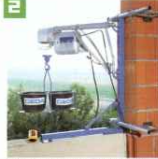
Оконное зажимное устройство регулируется для толщины стен от 16 см до 50 см и удобно в применении на большинстве оконных проемов. При наличии вертикальной обвязки оконной коробки точки опоры можно регулировать.
