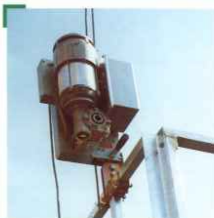
Приводные узлы могут также устанавливаться по концам платформы в специальных точках крепления. Такой вариант установки привода дешевле использования С-образного бугеля
