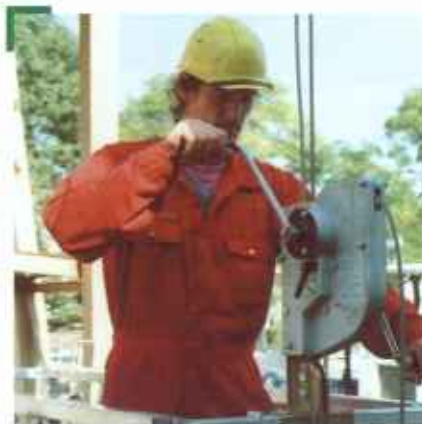
Во взрывоопасных зонах вместо электрического двигателя может использоваться очень эффективный ручной привод.
