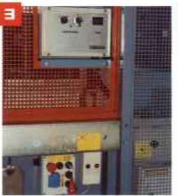
3 Die Steuerung des GEDA® 7P/15P ist vom Fahrkorb, der Bodenstation und jeder Etagentür aus möglich. Eine Etagentüvorwahlsteuerung erlaubt das automatische Anfahren von Ladestellen.
