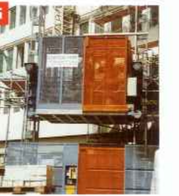
6 Beim Einfahren in die Bodenstation wird die vordere Kabinentür automatisch entriegelt und kann zusammen mit der Schiebetür der Bodenstation geöffnet werden.
