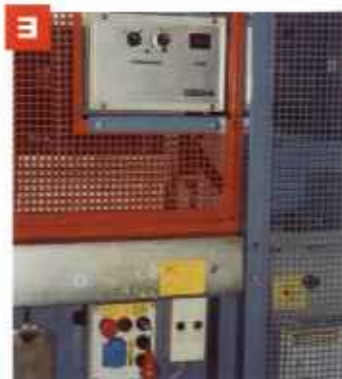
3 Die Steuerung des GEDA® 7P/15 P ist vom Fahrkorb, der Bodenstation und jeder Etagentür aus möglich. Eine Etagenwahlsteuerung erlaubt das automatische Anfahren von Ladestellen.
